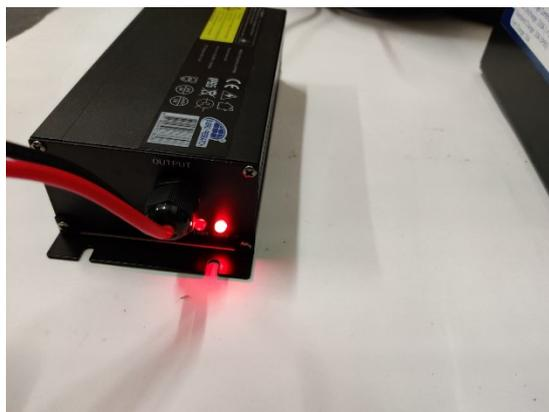
1. Connectez le chargeur à la batterie, la Led1 s'allume en rouge, ce qui signifie que le chargeur est correctement connecté à la batterie.
